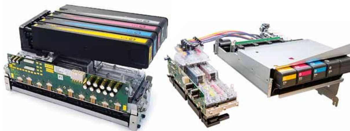
↑ Tiskárny HP PageWide využívají dva způsoby umístění inkoustových zásobníků zásobujících statické tiskové hlavy inkoustem. Vlevo je znázorněna sestava čtyřbarevného vykreslovacího modulu v ose a vpravo mimo osu.
