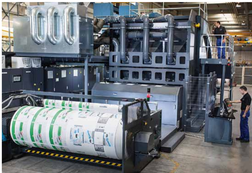
↑ HP PageWide Web Press T1100S, nejrychlejší produkční tiskárna s šířkou 2,8 m a rychlostí 183 m/min.
