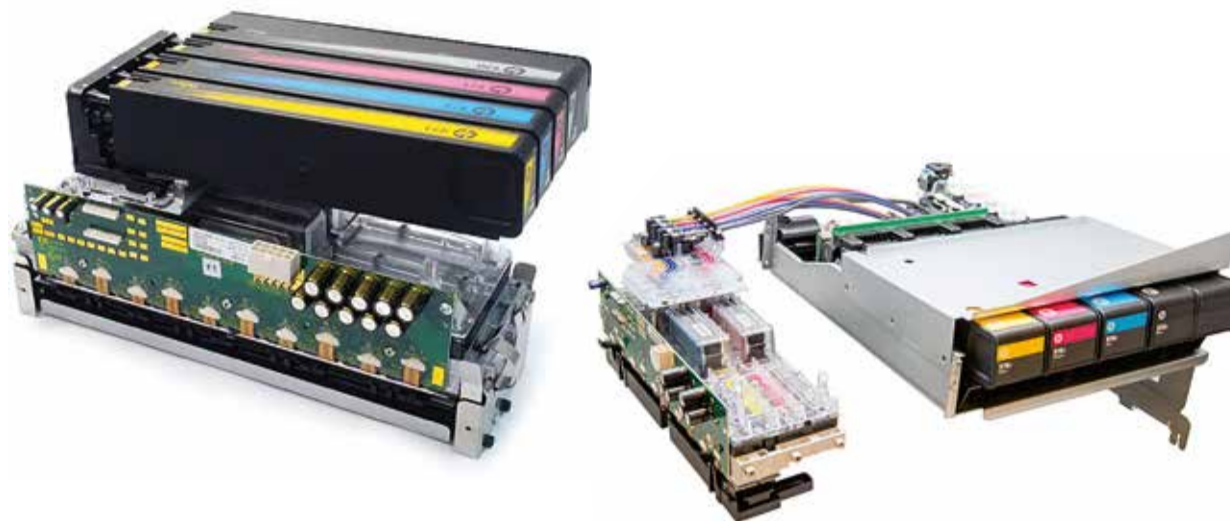
↑ Tiskárny HP PageWide využívají dva způsoby umístění inkoustových zásobníků zásobujících statické tiskové hlavy inkoustem. Vlevo je znázorněna sestava čtyřbarevného vykreslovacího modulu v ose a vpravo mimo osu.
